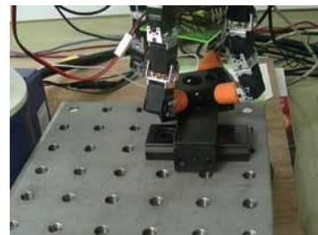
治具の組付け
